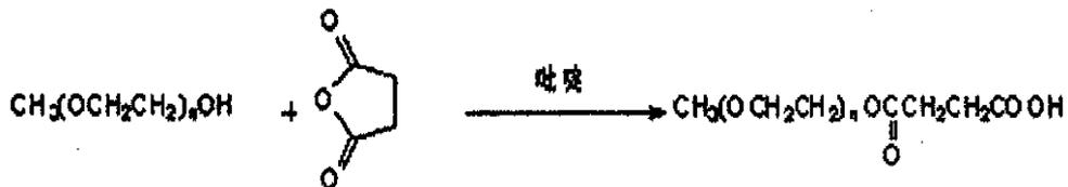
称取 100g, 20 mmol/L mPEG5(分子量为 5000), 放入圆底烧瓶中, 用 500 mL 吡啶溶解, 再加入琥珀酸酐(4g, 40 mmol/L), 反应后, 蒸去大部分吡啶, 所得固体用双蒸水透析提纯, 去除 mPEG 及其未反应完全的反应物。然后将透析
